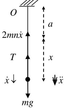
$mg - T - 2mn\dot{x} = m\ddot{x}$ $mg - \frac{2man^2x}{a} - 2mn\dot{x} = m\ddot{x}$ $\ddot{x} + 2n\dot{x} + 2n^2x = g \quad (*)$                                                                                                                                                                                                                                                                                         | M1 A1 A1<br>M1<br>A1 (5)                                  |
